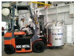
② การใช้ระบบสุญญากาศสูบลูมิเนียมเหลว
