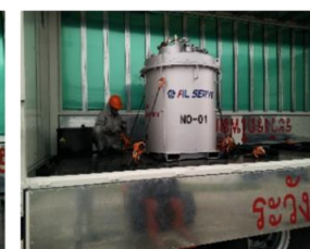
⑧ การตักภาชนะและการจัดเตรียมอะลูมิเนียมเหลวส่งลูกค้า
