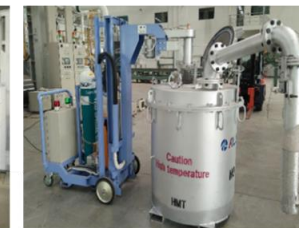
③ การไล่อากาศด้วยก๊าซอาร์กอน
