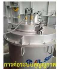
② การใช้ระบบสุญญากาศสูบลูมิเนียมเหลว
